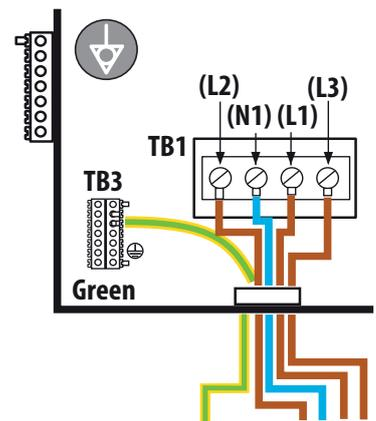
dimensionare in base all'assorbimento di corrente (massimo o alternativo) / size based on current absorption (maximum or alternative)
